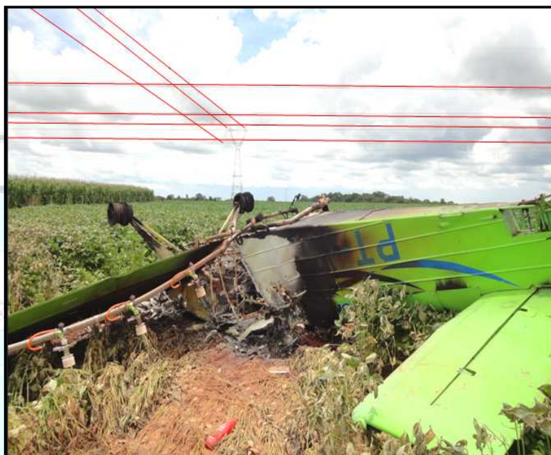
Figura 2 - Em destaque os fios de alta tensão sobre a área a ser voada.
