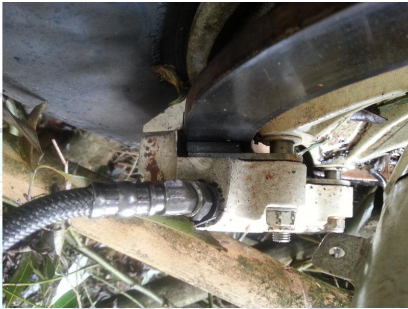
Figura 4 - Pastilha freio esquerda colada ao disco.
