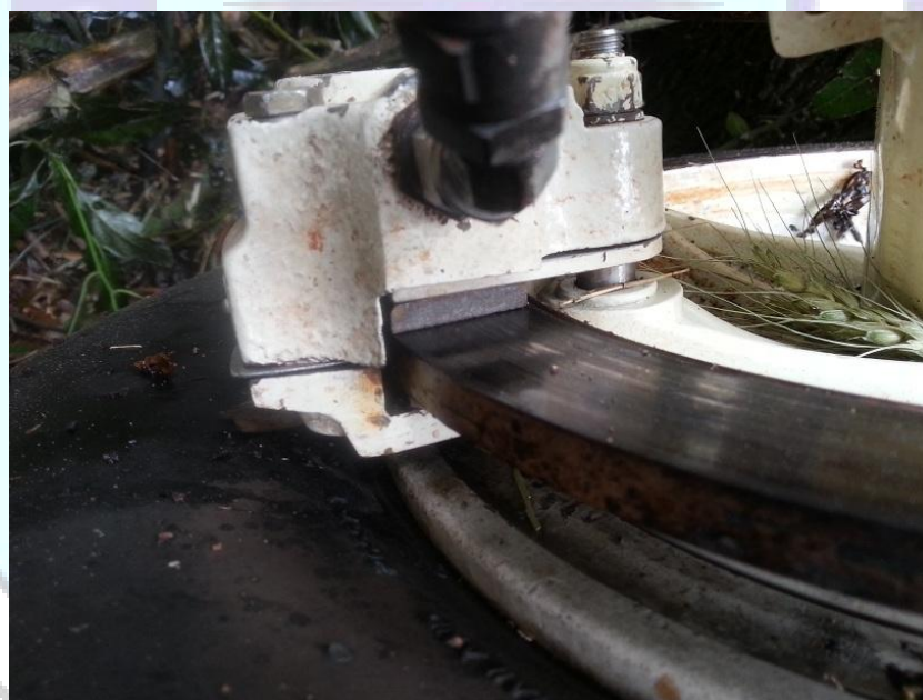
Figura 4 - Pastilha freio direita colada ao disco.
