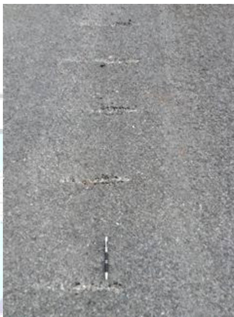
Figura 4 - Marcas da hélice no asfalto.
