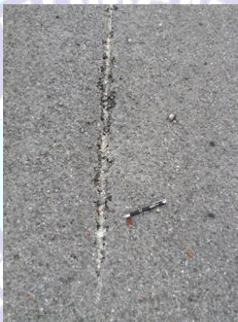
Figura 3 - Primeira marca na pista deixada pela aeronave.
