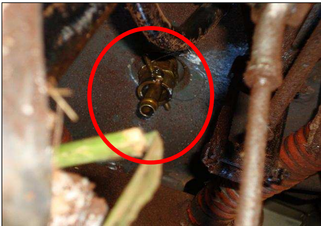
FOTO 02 - DRENO DE ÓLEO DO MOTOR NA POSIÇÃO ABERTO
