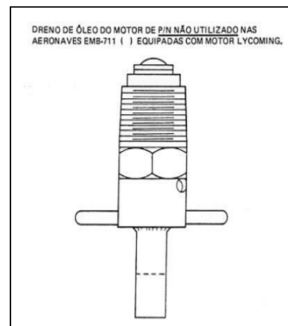
FIGURA 02 – TIPO DE DRENO QUE NÃO PODERIA SER INSTALADO, SEGUNDO O BS 700-01-0008
