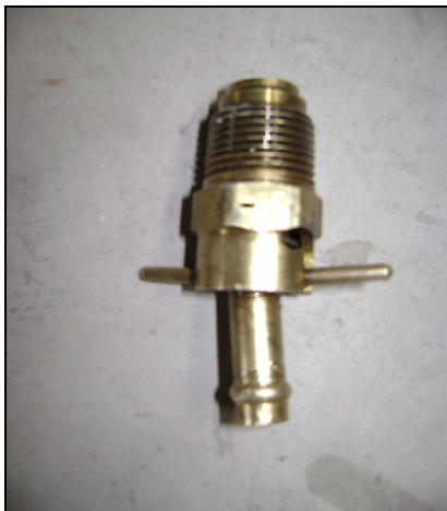
FOTO 06 - DRENO INSTALADO NA AERONAVE
