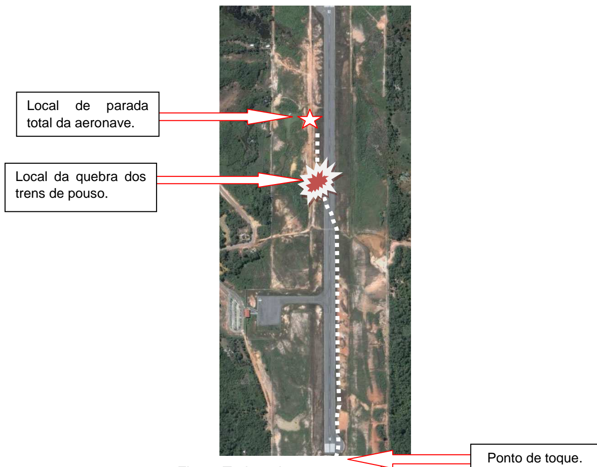
Fig. 1: Trajeto da aeronave após o pouso.
