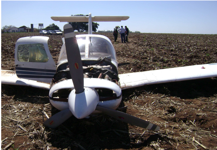
Foto nº1: Situação da aeronave após o pouso - pás da hélice com indícios de que a aeronave tocou o solo sem potência.
