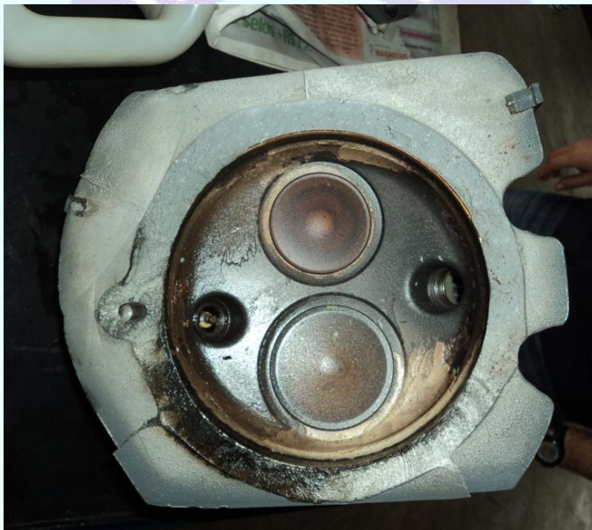
Figura 2 - Local do vazamento dos gases resultantes da combustão e onde se iniciou a fadiga. |
