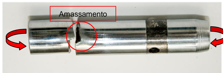
Figura nº3 Mecânica da sobrecarga
