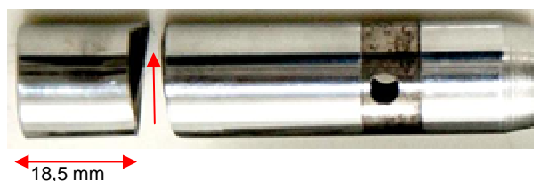
Figura nº2 Direção da fratura do trunnion pin
