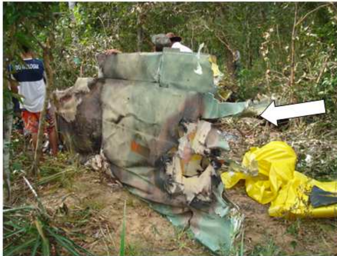
Figura 1: Detalhe de seccionamento da asa do PP-XIG pela ação da hélice da aeronave PT-KYD.
