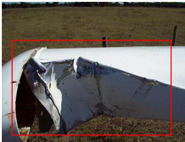
Figuras 4 e 5: Detalhes do choque na asa direita da aeronave PT-KYD.
