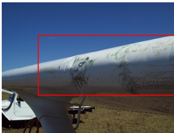
Figuras 6 e 7: Detalhes na parte superior e bordo de ataque da asa direita do PT-KYD.
