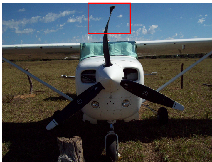
Figura 3: Danos na ponta da hélice da aeronave PT-KYD.
