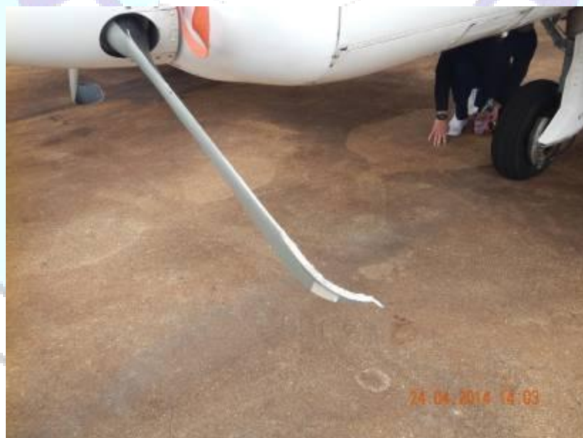
Figura 2 - Hélice do motor 1 avariada.
