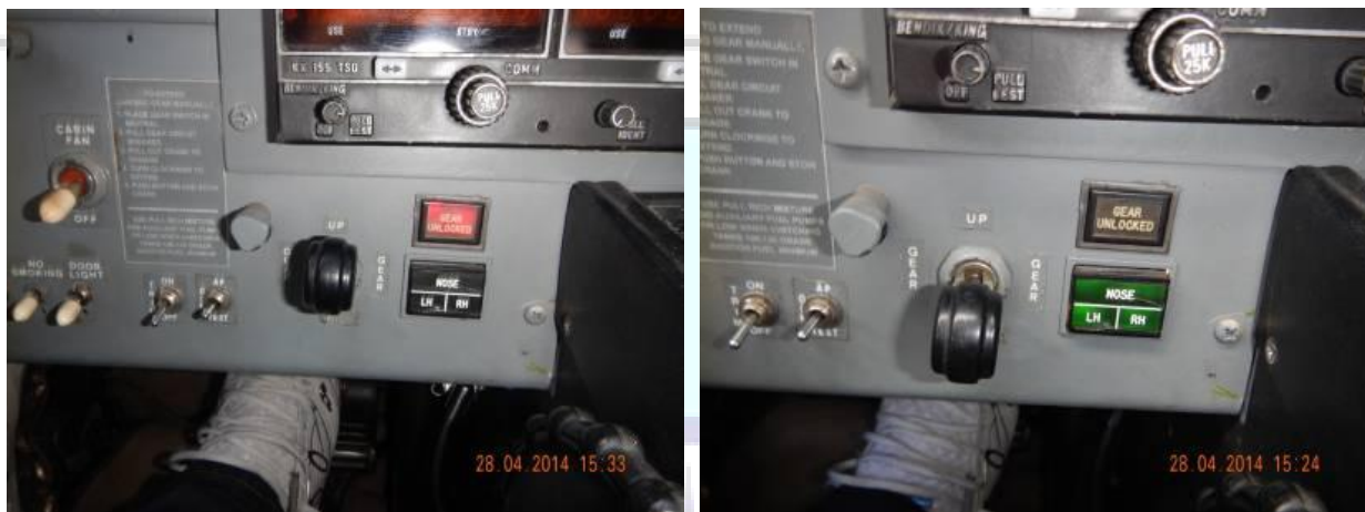
Figuras 4 e 5 - Luzes de aviso de trem de pouso em transição e baixado e travado respectivamente.
