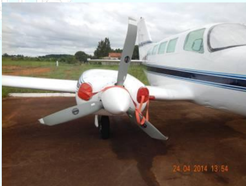
Figura 1 - Hélice do motor 2 avariada.
