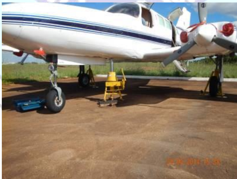
Figura 3 - Aeronave suspensa por macaco hidráulico para realização de teste.
