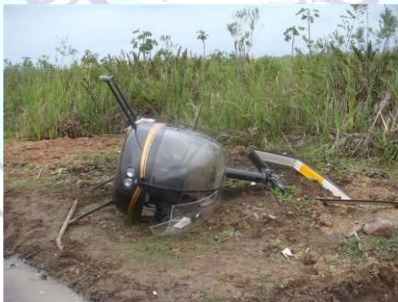
Figura 2 - Vista frontal (cabine e rotor principal danificados).
