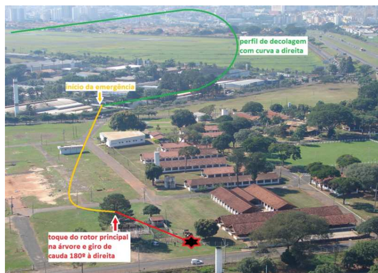
Figura 7 - Esquema representativo da trajetória da aeronave.
