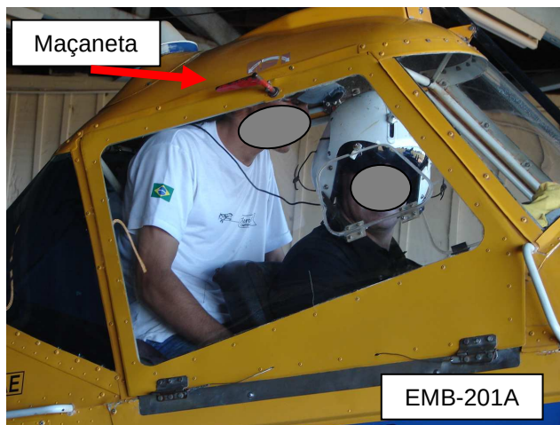
Foto 03: Cabine da aeronave EMB-201A com posicionamento irregular de um passageiro atrás do assento do piloto. Destaque para maçaneta existente na parte interna e externa da aeronave, em ambos os lados.
