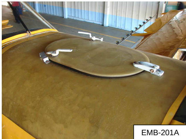
Foto 01: Vista do compartimento de defensivos agrícola ( hopper ).
