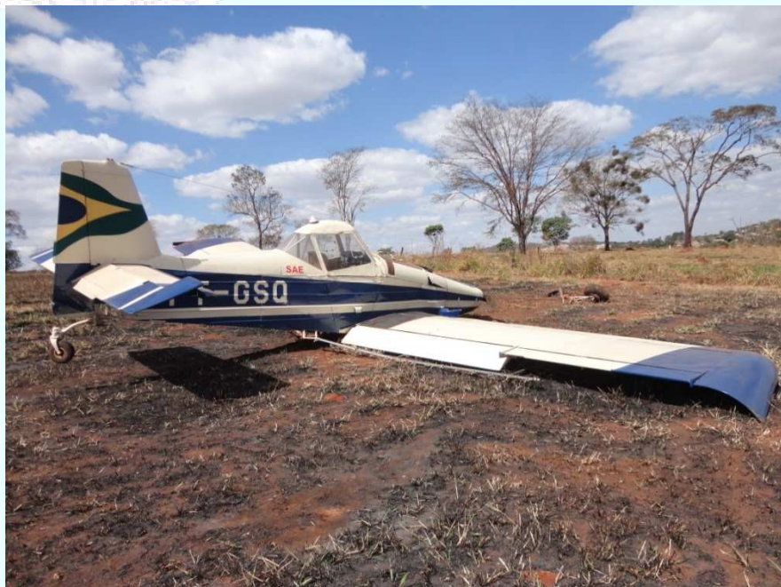
Figura 1 - Estado geral da aeronave após o acidente.
