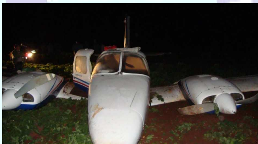
Figura 02 - Aeronave vista de frente com as hélices visivelmente danificadas.
