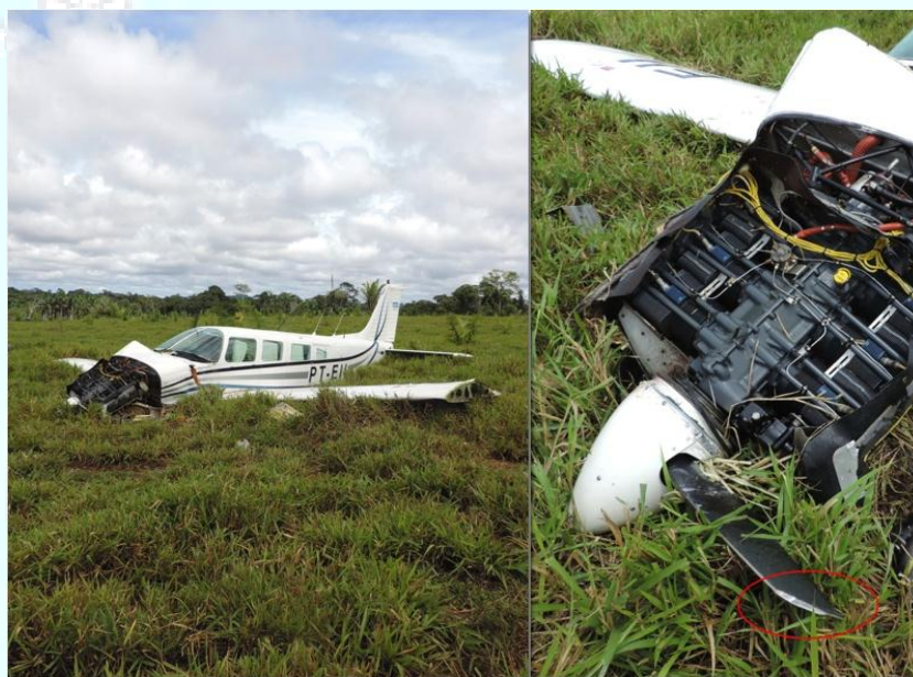
Figura 1 – Situação da aeronave após a ocorrência e os danos do motor e da hélice sem a ponta de uma das pás (em destaque).
