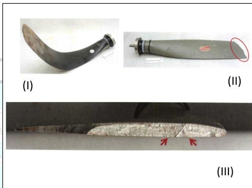
Figura 4 - (I) Pá de hélice deformada por impacto. (II) Pá da hélice fraturada (elipse em destaque) e (III) Detalhes das superfícies de fratura resultantes do rompimento.
