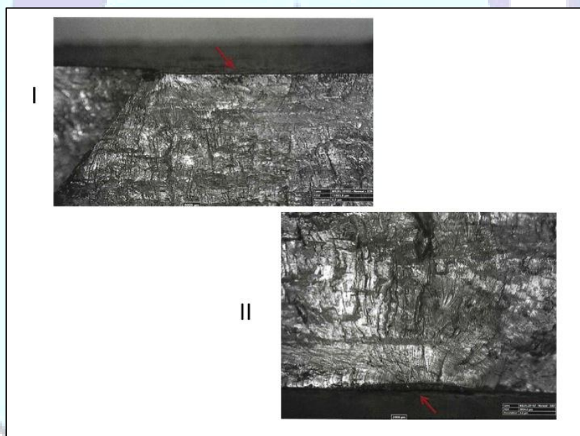
Figura 5 -: (I) Origem da fadiga na primeira área indicada pela seta (II) Origem da fadiga na segunda área indicada pela seta.
