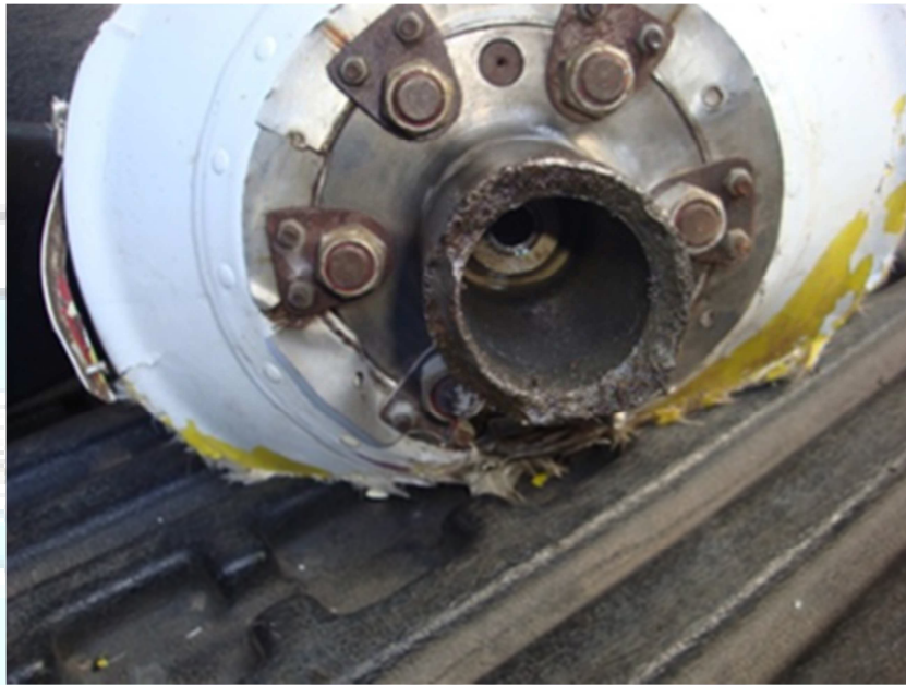
Figura 6 - Eixo de manivelas fraturado.
