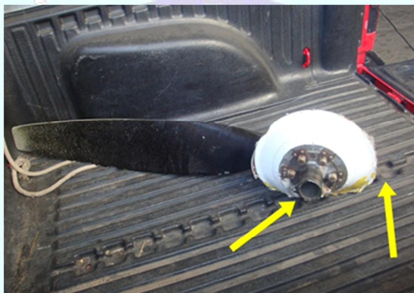
Figura 2 - Danos no conjunto da hélice.
