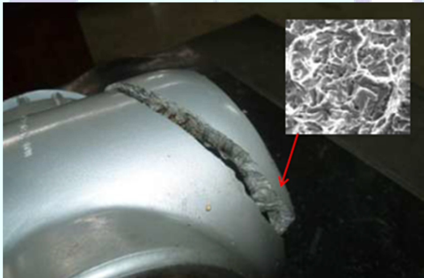
Figura 5 - Vistas macro e micro estrutural da trinca.
