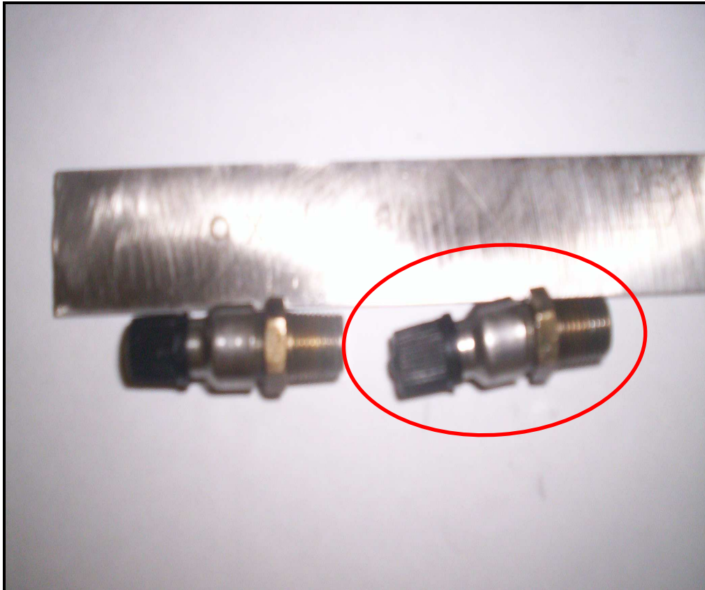
Foto 01. Bico injetor deformado.
