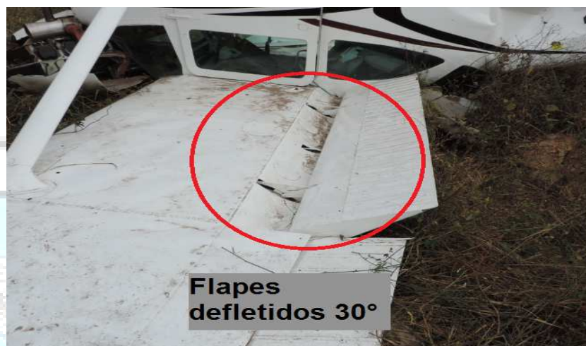
Figura 4 - Superfície do flape defletido a 30°.
