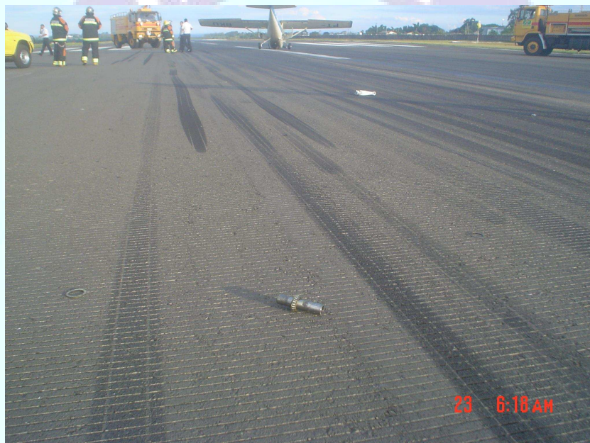
Figura 2 - Partes da perna de força dianteira espalhadas no trajeto da aeronave.
