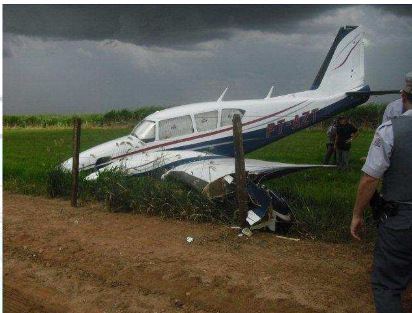
Figura 1 - Posição de parada da aeronave, após impacto contra a cerca.
