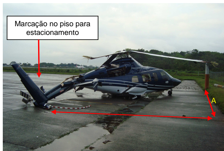
Figura 7 - Distância entre o poste e o prolongamento da marca de estacionamento A: 13,5m.
