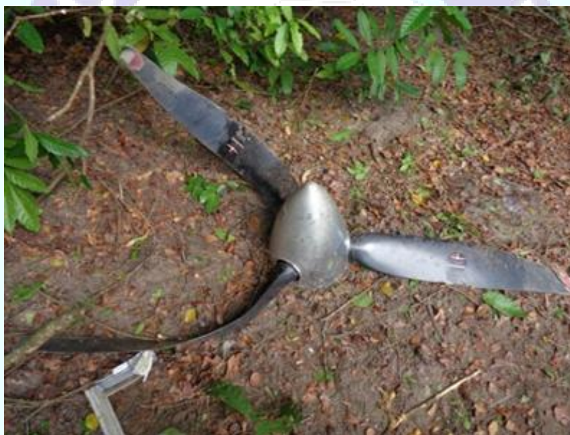
Figura 3 - Condição das pás da hélice após o acidente.
