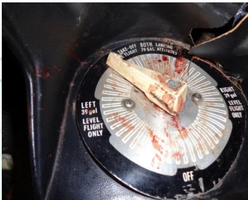
Figura 4 - Posição da seletora de combustível após o acidente.
