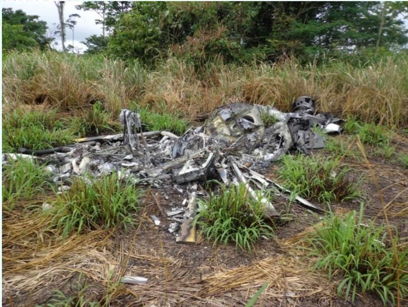
Figura 1 - Destroços da aeronave após a ação do fogo.
