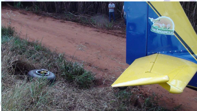
Figura 2 - Danos na roda do trem de pouso principal esquerdo.
