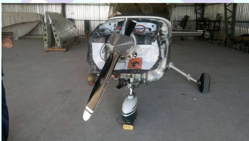
Figura 2 - Situação da pá da hélice da aeronave após a ocorrência.
