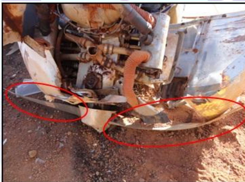
Figura 2 - Torção da pá da hélice indicando baixa potência do motor no momento do impacto.
