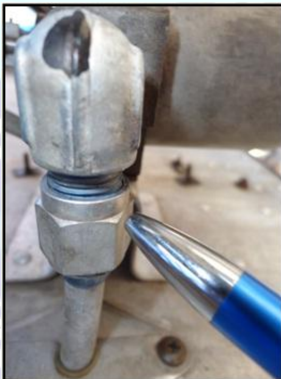
Figura 4 – Nipple ajustado em outra aeronave, indicando a diferença entre o encontrado e o previsto.
