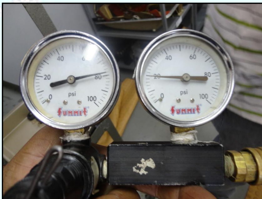
Figura 6 – Cilindro 3 com baixa taxa de compressão (20 PSI).
