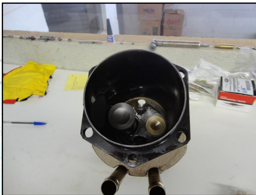
Figura 7 – Cilindro 1 com a válvula de admissão travada na posição aberta.
