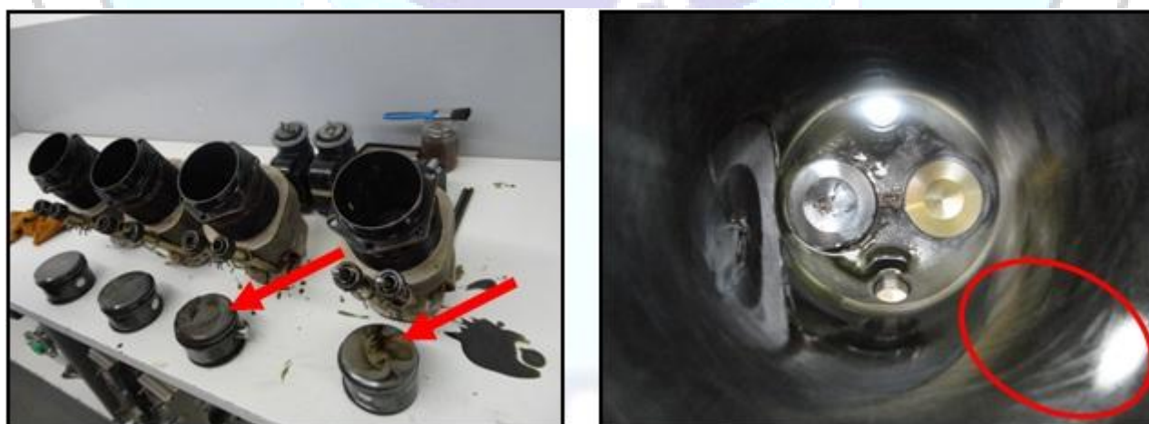
Figura 8 – Cilindros com presença de óleo e fenômeno do espelhamento na parede interna.
