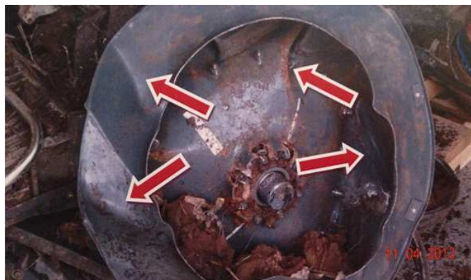
Figura 9 – Vista mostrando as deformações por torção.
