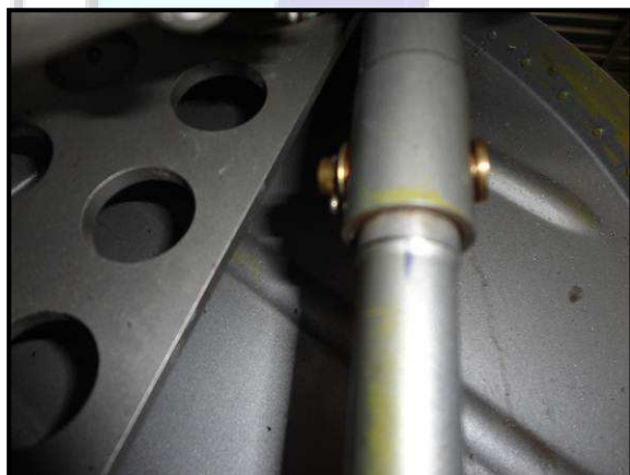
Figura 2 - Haste do trem de pouso instalada na aeronave.
