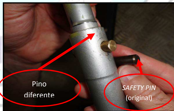
Figura 5 - Comparativos entre um pino original e o instalado na aeronave.
