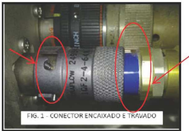
Figura 1 e 2 - O colar azul significa a indicação do correto travamento.
