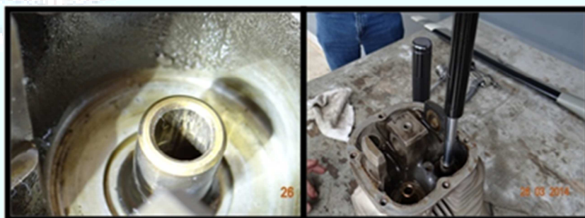
Figura 8 - Vista geral da guia de válvula de admissão do cilindro 4 com fortes marcas de ranhuras e verificação com o calibre “go/no-go” do diâmetro da guia da válvula de admissão do cilindro 4.
