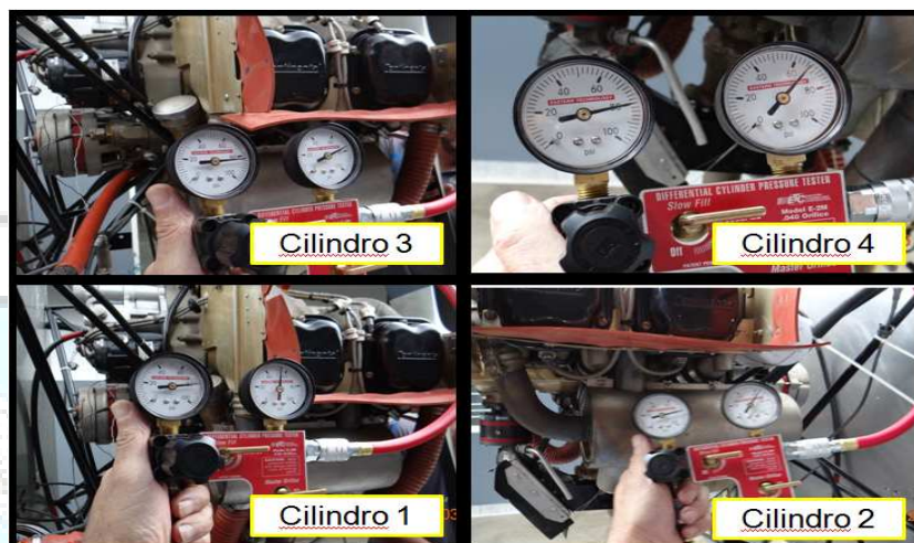
Figura 5 - Verificação da compressão dos cilindros 3, 4, 1 e 2, após o funcionamento do motor.
