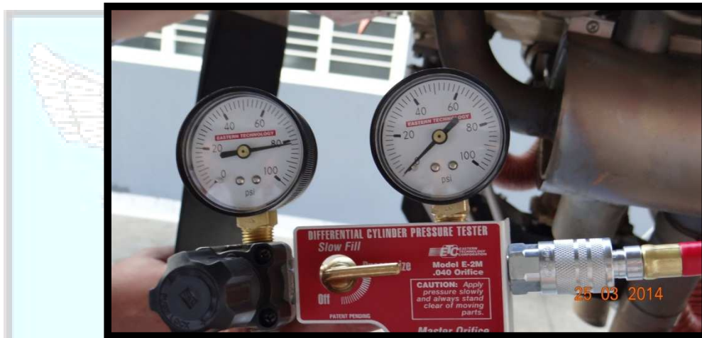
Figura 3 - Verificação da compressão do cilindro 4 com o motor frio.
