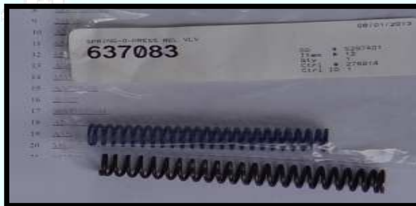
Figura 9 - Comparação com a mola (embalagem) que deveria ser montada de acordo com o manual do motor.
