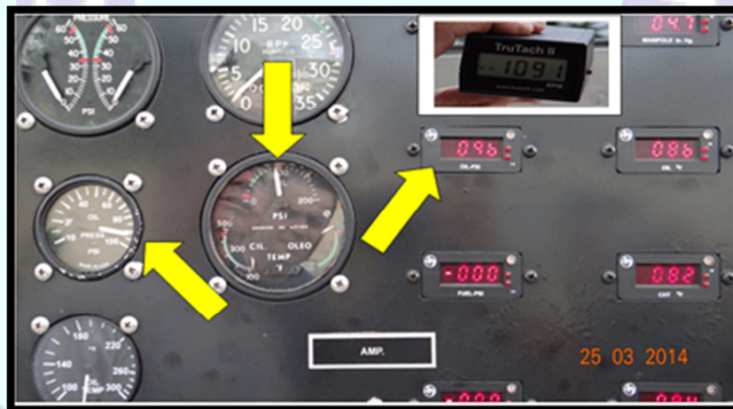
Figura 4 - Durante a verificação dos parâmetros do motor, observa-se que a pressão de óleo estava alta.
