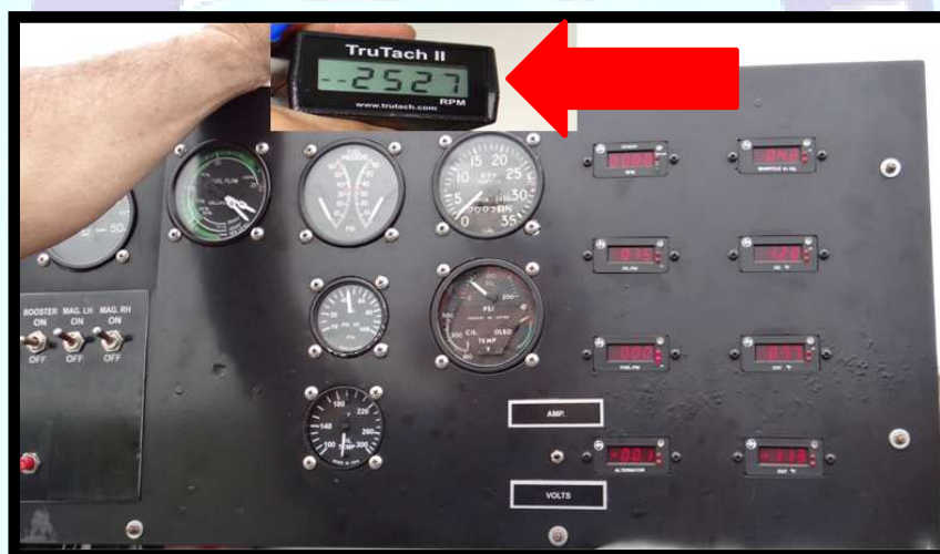
Figura 6 - Vista geral dos parâmetros do motor no regime de rotação máxima. No destaque é mostrada a rotação do motor.
