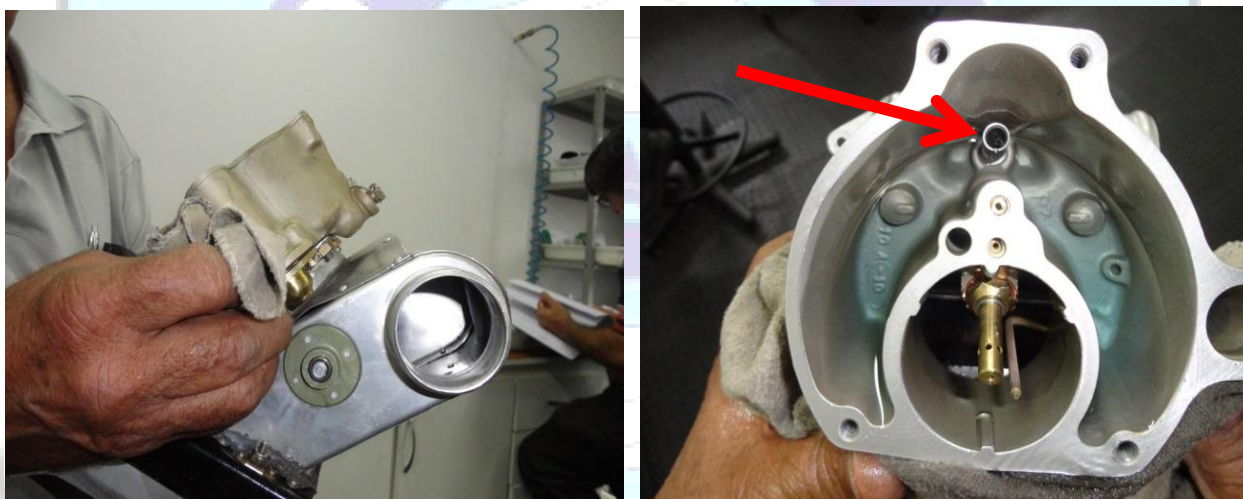
Figuras 8 e 9 – À esquerda, o carburador da aeronave em simulação de elevado ângulo de arfagem. À direita (seta), observa-se, para a mesma inclinação, a saída do injetor de descarga do carburador sem contato com o combustível existente na cuba.
