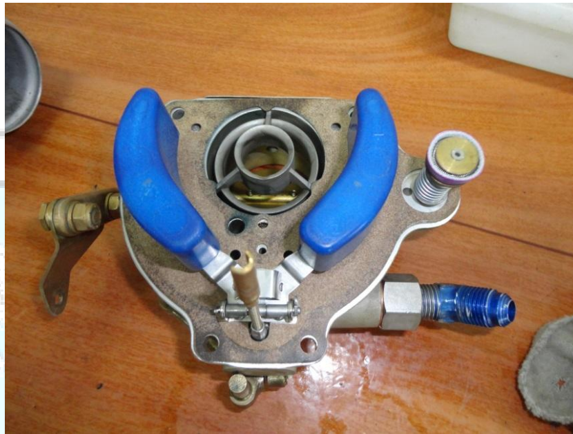
Figura 5 – Carburador instalado na aeronave no momento do acidente e aberto em bancada.
