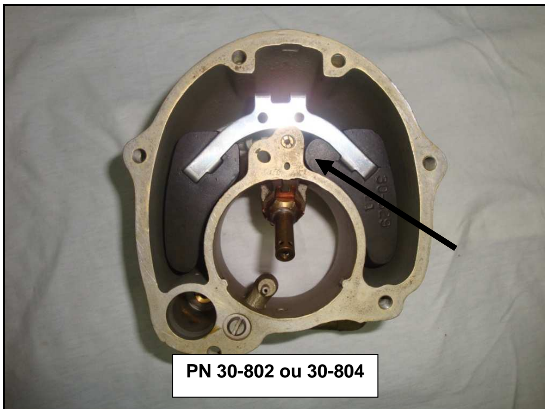
Foto 01 – Bóia de polímero encaixada na cuba do carburador. Em destaque o ponto em que ocorre o atrito do flutuador da bóia com a parede interna da cuba.
