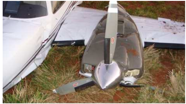
Figuras nº2 e nº3 Detalhes das hélices esquerda e direita.
