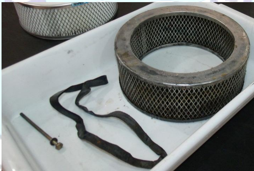
Figura 3 - Filtro de ar da aeronave com total desprendimento da junta de vedação.
