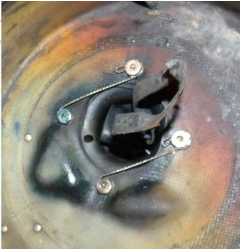
Figura 2 - Junta de vedação do filtro de ar retida no venturi.
