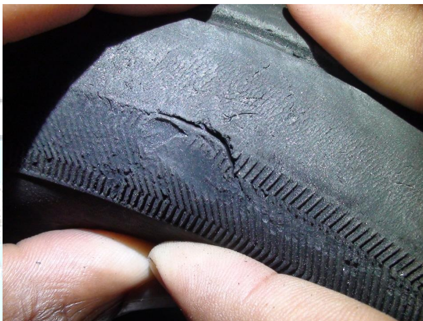
Figura 4 - Dano na banda de rodagem do pneu.
