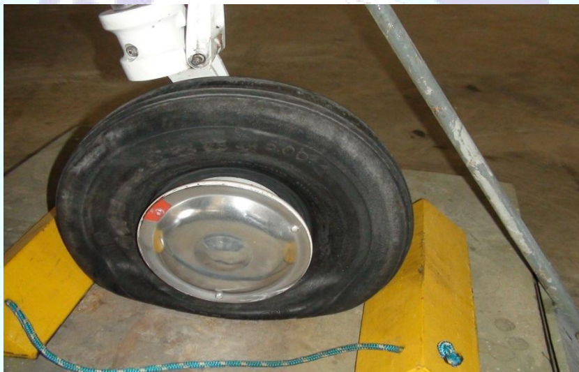
Figura 2 - Pneu de nariz desinflado.
