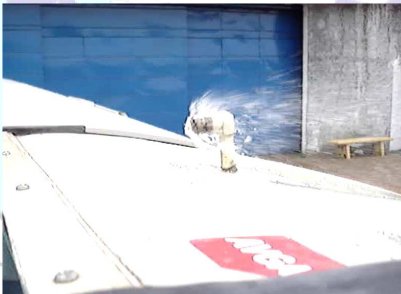
Figura 4 - Vazamento de combustível pelo suspiro do tanque superior durante o giro de teste.
