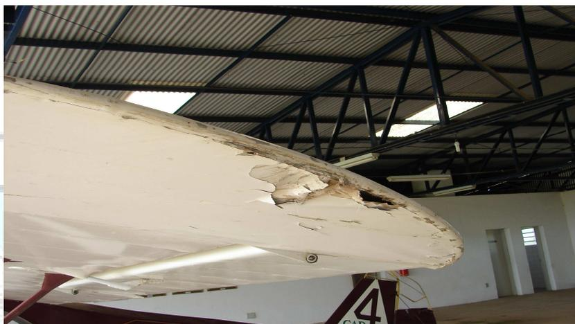
Figura 1 - Danos sofridos pela asa esquerda da aeronave.
