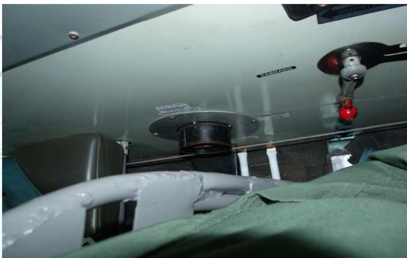
Figura 5 - Vista da seletora de combustível quando o piloto está no assento dianteiro.
