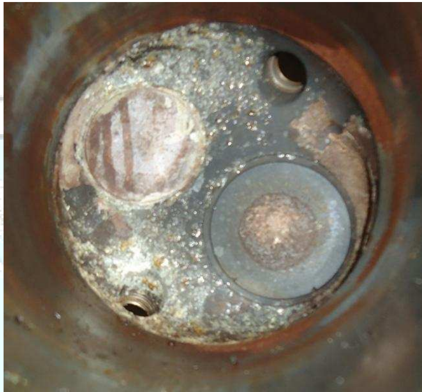
Figura 2 - Visão interna do cilindro 3 com acúmulo de chumbo da AVGAS.
