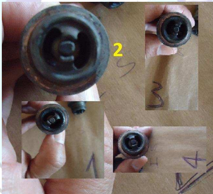
Figura 1 - Velas de ignição carbonizadas e com acúmulo de chumbo.
