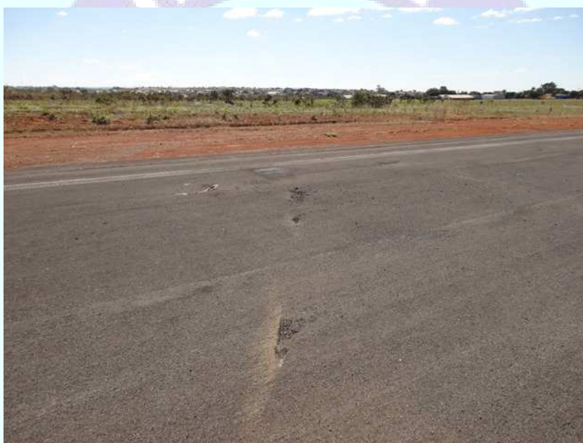
Figura 3 - Marcas deixadas pela colisão da hélice e do spinner com o solo.
