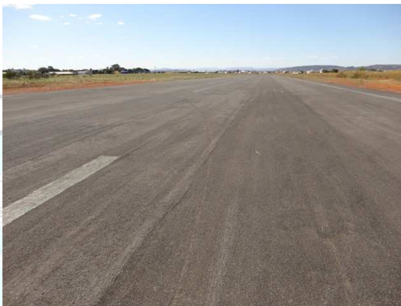
Figura 2 - Marcas deixadas pela aeronave no solo ao perder a reta para a esquerda.
