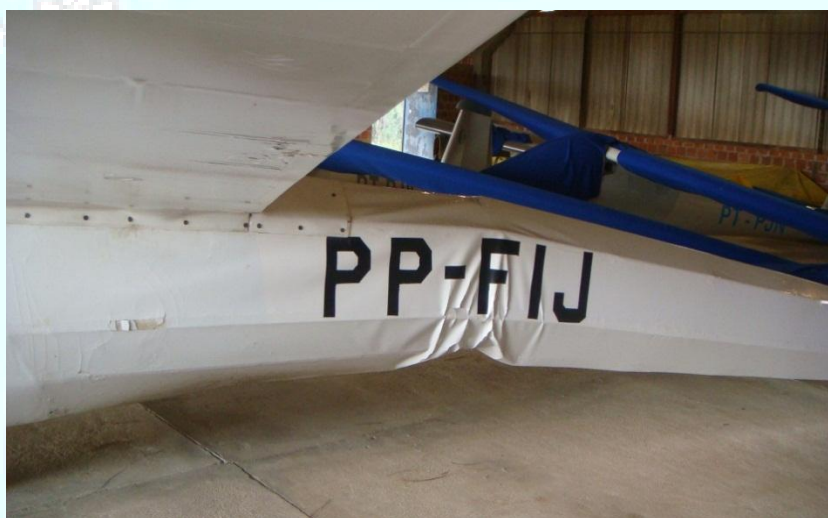
Figura 1 - Vista dos danos ao planador. |
