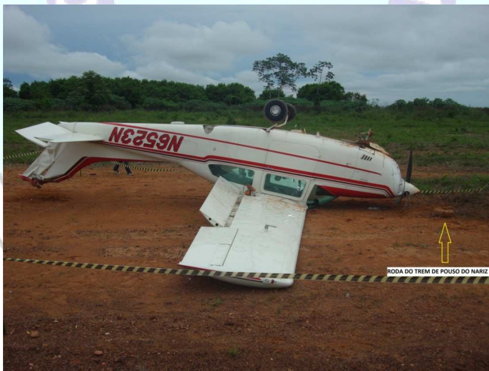
Figura 2 - Situação da aeronave, após o capotamento.
