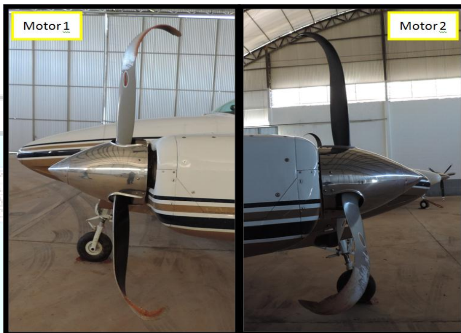
Figura 5 - Deformação das hélices após o impacto.
