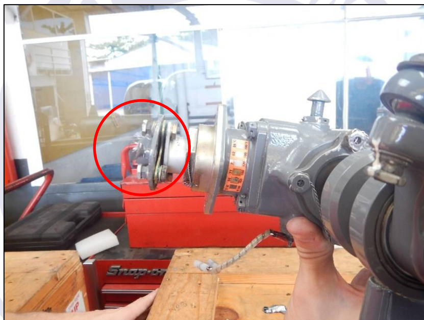
Figura 4 - Ponto de rompimento do eixo de transmissão.
