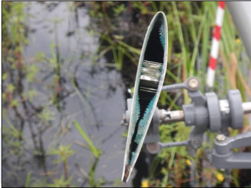
Figura 2 - Ausência da ponta da pá do rotor.
