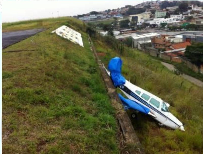
Figura 1 - Aeronave parada após ultrapassar os limites da pista.
