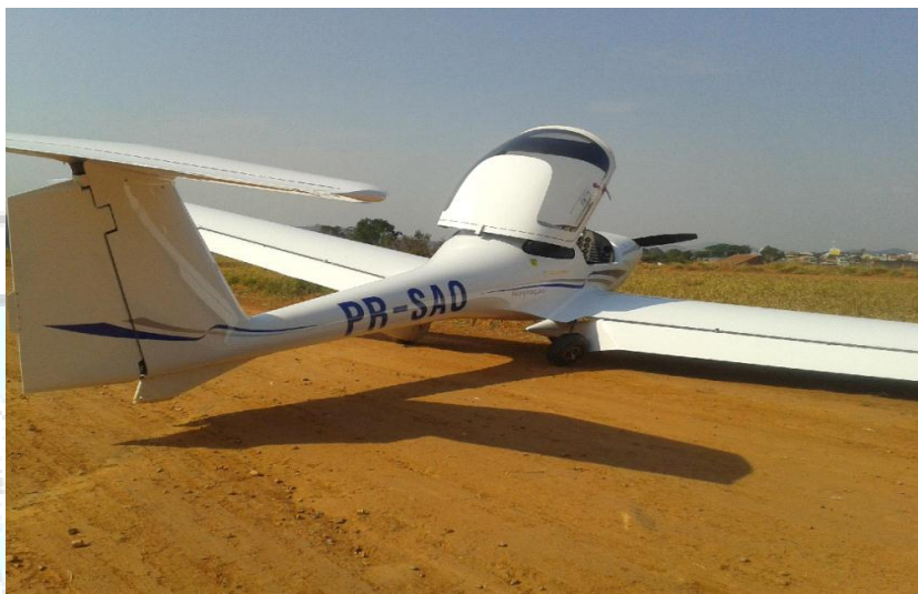
Figura 2 - Vista dos danos no trem de pouso e nos flapes.
