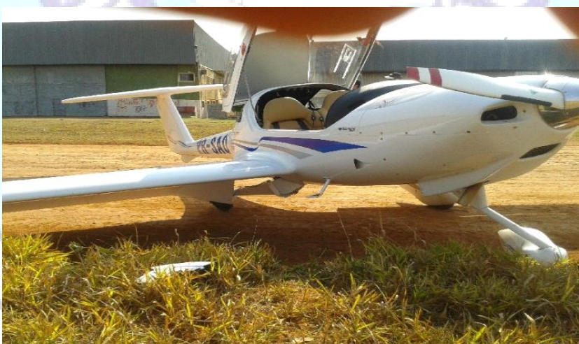
Figura 4 - Vista dos danos no trem de pouso e nos flapes. |
