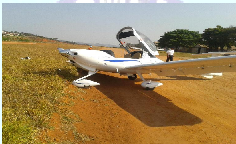
Figura 3- Vista dos danos no trem de pouso e nos flapes.
