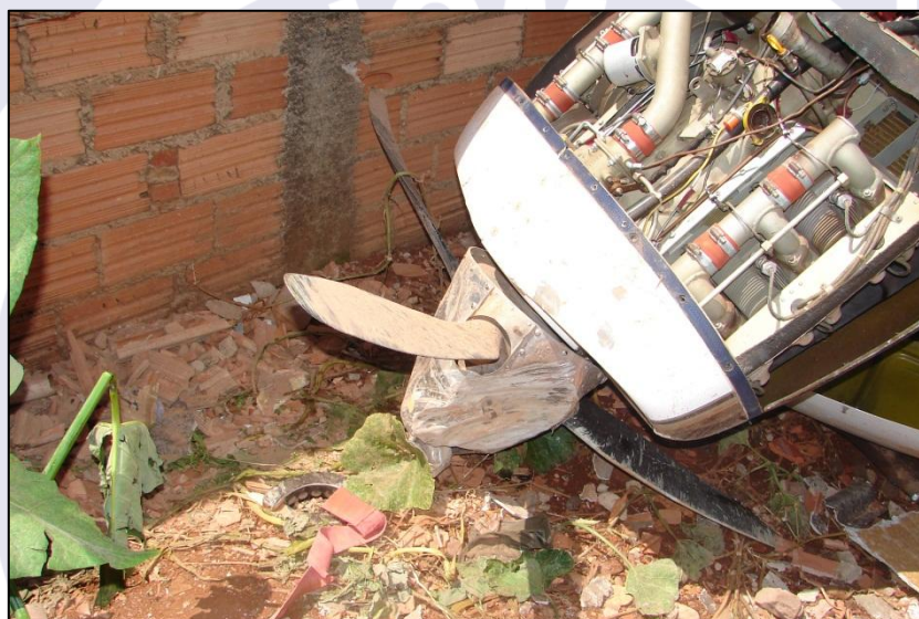
Figura 3 – Hélice esquerda com poucas deformações.
