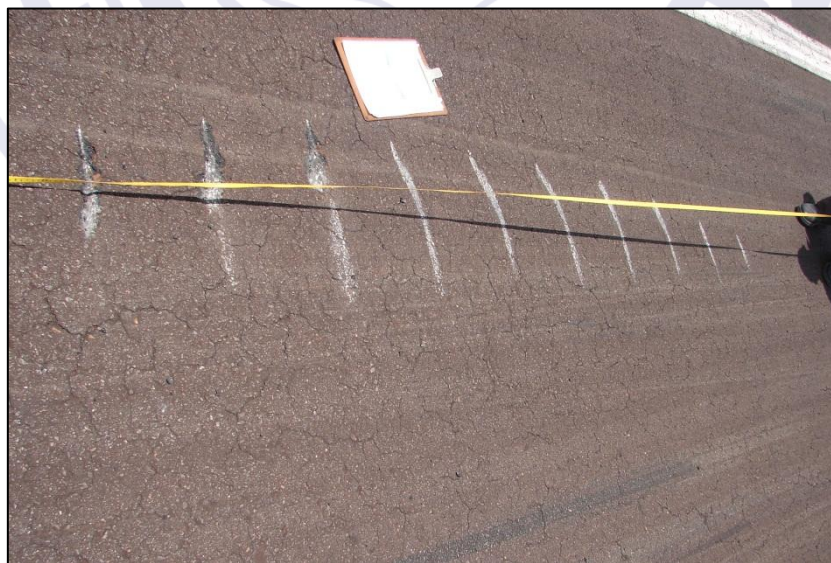
Figura 1 – Marcas do toque da hélice direita na pista de SWNV.
