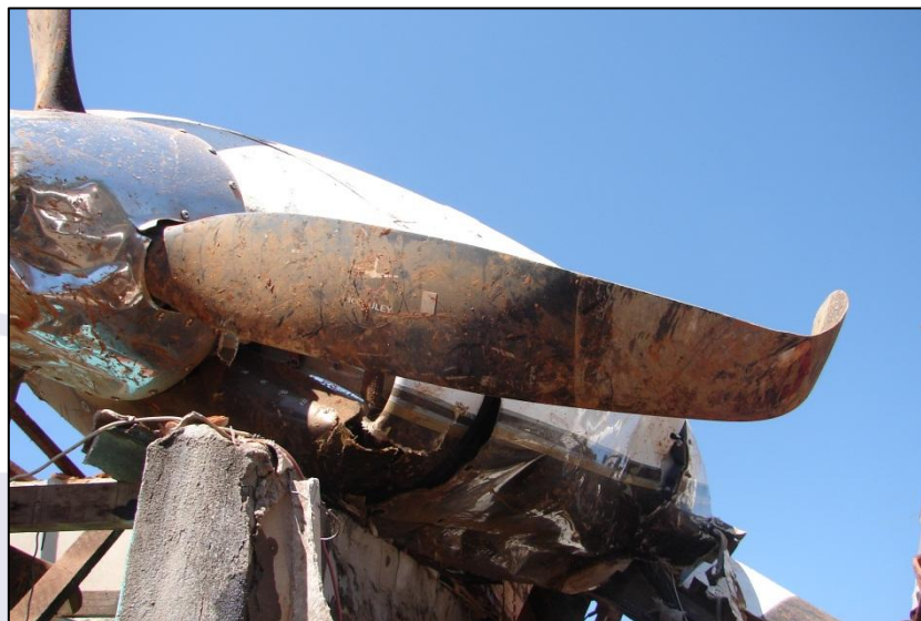
Figura 2 – Deformações nas pás da hélice direita.
