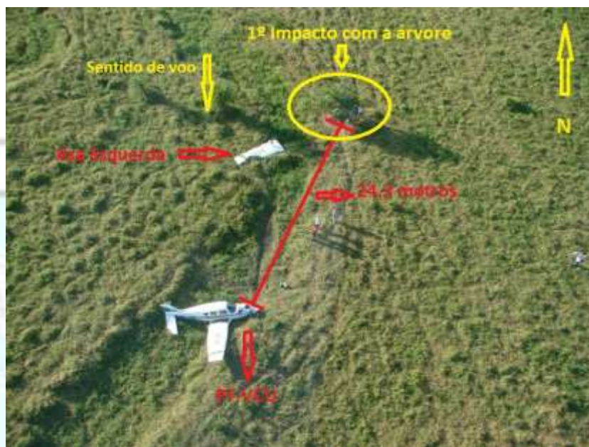
Figura 2 - croqui do impacto e dos destroços da aeronave.
