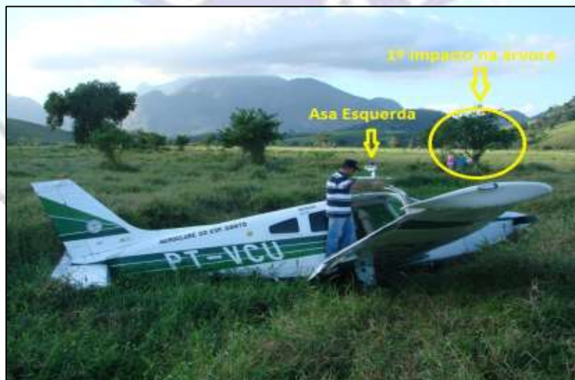
Figura 1 - Primeiro impacto com a árvore visto a partir do local de parada final da aeronave. No meio da foto é possível ver o trem de pouso esquerdo do avião junto com a asa esquerda.
